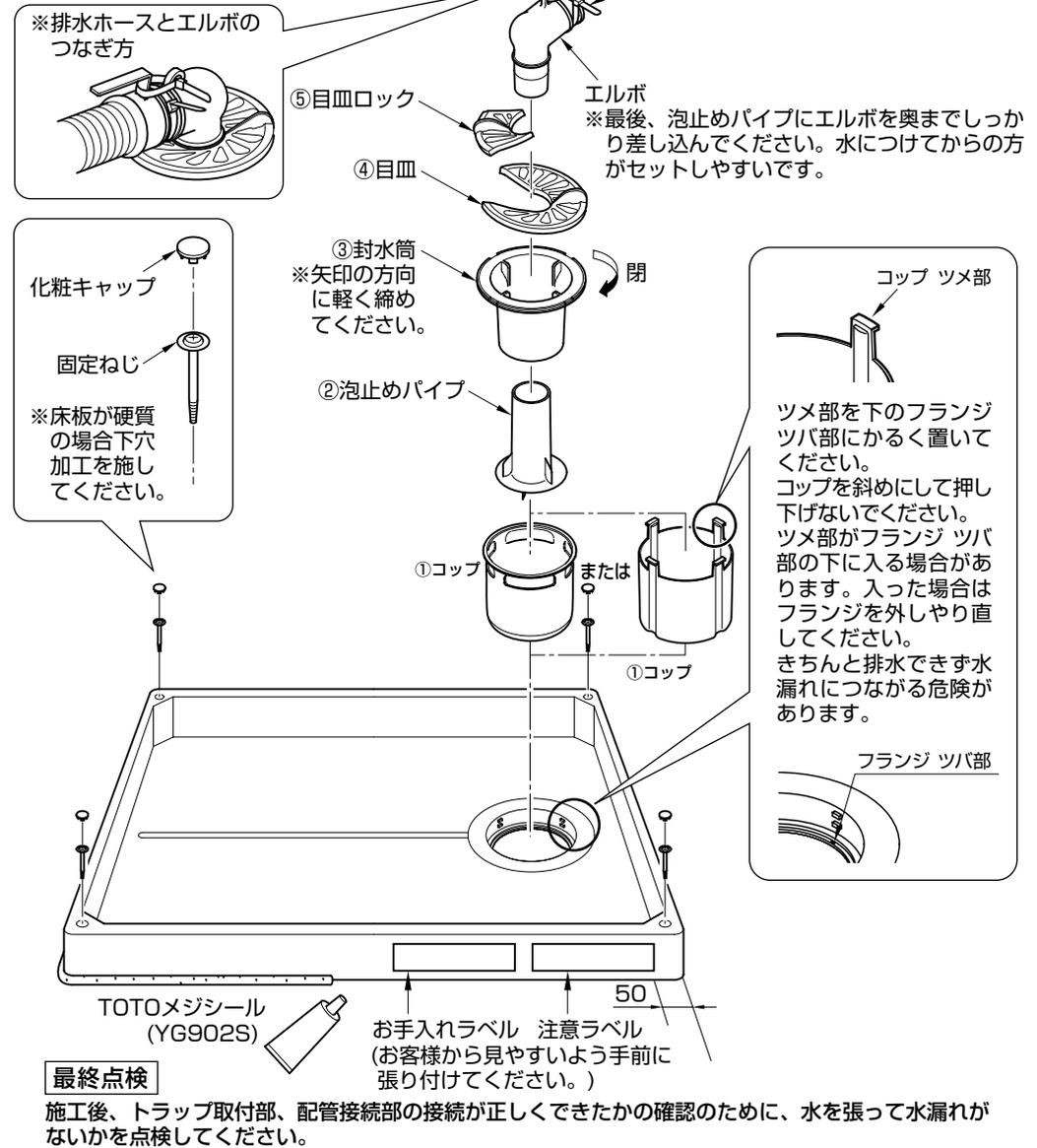
**最終点検** 施工後、トラップ取付部、配管接続部の接続が正しくできたかの確認のために、水を張って水漏れがないかを点検してください。
