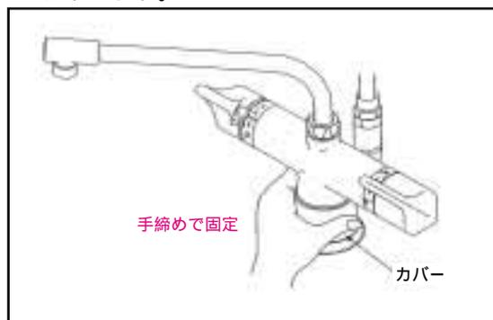
④ 止め輪・取付座を元に戻した後、取付座に水栓を挿入し、カバーを手で締め付け固定します。
