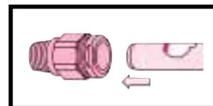
④ パイプを継手に押し込みます。シールの平面(赤線)が継手の端面まで入ると正しい施工です。
