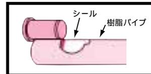
② はがしたシールをインコア挿入部の長さに合わせ、樹脂パイプに貼付します。
