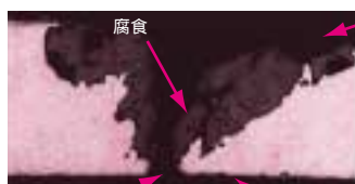
腐食 パイプ内面 貫通穴 パイプ外面
