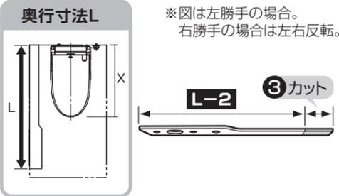
**2 ブラケットの取り付け** ※紙巻器ブラケットはメタル製紙巻器の場合のみ。 ※樹脂製紙巻器の場合は直接紙巻器を取り付け。 ※図は左勝手の場合
