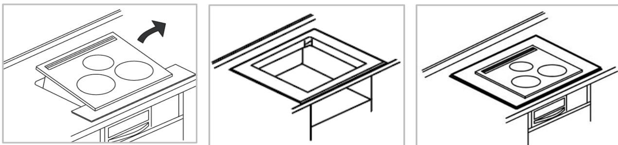
①既設のコンロを取り外す      ②アダプターを設置      ③新しいコンロを設置
