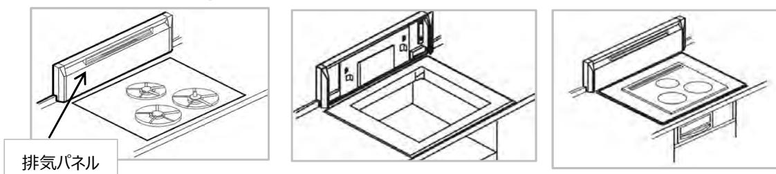
①既設のコンロを取り外す      ②アダプターを設置      ③新しいコンロを設置
