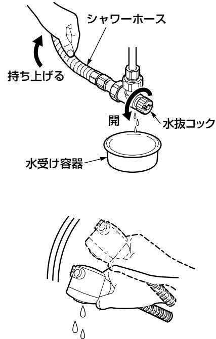
4. 水抜コックの下に水受け容器（洗面器など）を用意し、水抜コックを開ける。
