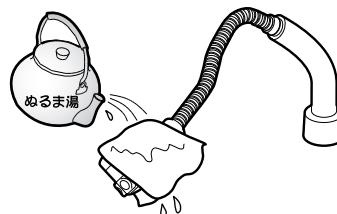
水抜きを行っても散水板の網目につ着した水滴が凍り、通水後も少しの間、水が出ない場合があります。
