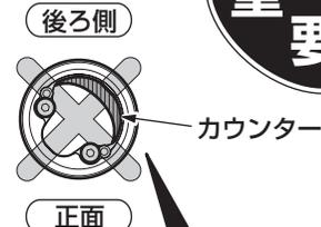
カウンターが見える状態で上面施工用アダプターを固定しないでください。
