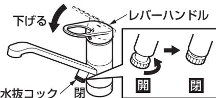
4. 水が抜けたら、レバーハンドル・水抜コックを閉める。(水抜き完了)
