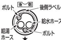
● **後ろ側ラベルの反対側のボルト★が正面になります。**
