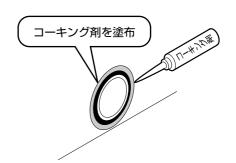
注)基礎貫通呼径50と75タイプは、スリーブベンド管の屋外側と排水可とう管との間にすき間がありますので、コーキングパッキンを均等にはめ込み、上からコーキング剤で止水処理をしてください。
