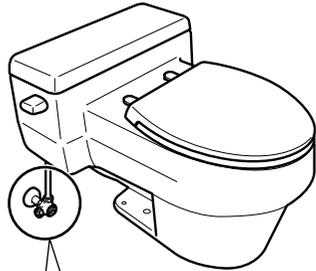
マイナスドライバーを差し込み、止水栓を閉める。
