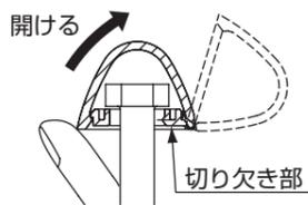
② 木ねじを取り付けたあと、化粧キャップを矢印の方向に「パチッ」と音がするまで押し込む。
