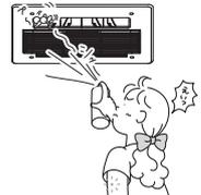
樹脂製品に付着した溶剤などを放置するとひび割れや、変色、材質の低下などの故障（落下）やサビの原因になります。
