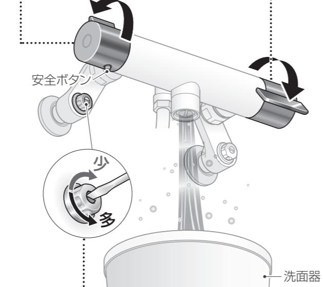
7 湯側止水栓で流量を調節する
