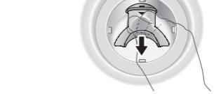
3 封水筒、排水トラップ内の汚れをスポンジで落とす
