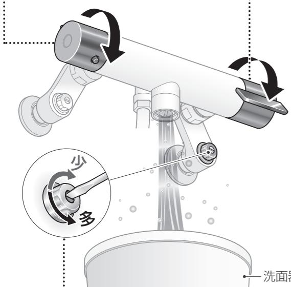
3 水側止水栓で流量を調節する
