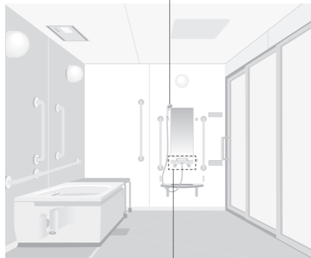
水栓金具・止水栓・吐水口
