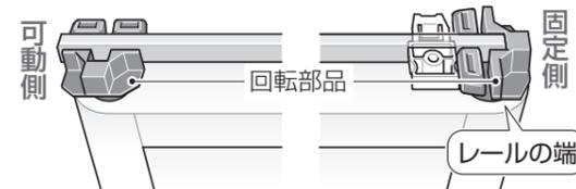
3 回転部品を押し下げて、溝にレールをはめる
