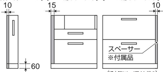
※(組立時にレイアウト端のキャビネットに取り付ける)
