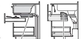
ガス配管保護カバー 排水金具ガード
