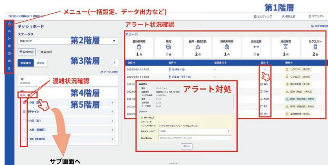
この画面では、アラートの発生状況を一目で確認できるほか、発生した場所や器具、使用状況の詳細、トイレの混雑表示などを確認できます。また、他の機能へ遷移するためのメニューバーも設定されています。詳細はダッシュボード（建屋）のページをご確認ください。
