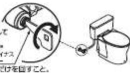
②ふた固定金具を外し、タンクふたと結露防止カバーを外す。
