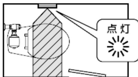
※センサーが壁やドアを感知していると正確に人体を感知できず、大小洗浄の判定や自動洗浄ができなくなります。
