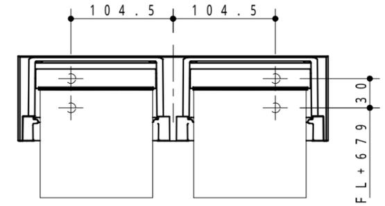
タイル・コンクリート壁の場合は、下記位置にねじ先端と壁の干渉を防ぐための穴(φ5)をあけてください。
