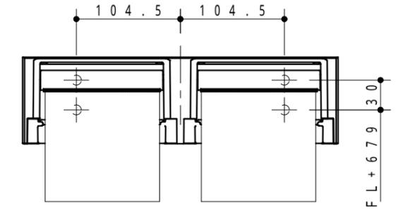
タイル・コンクリート壁の場合は、下記位置にねじ先端と壁の干渉を防ぐための穴(φ5)をあけてください。
