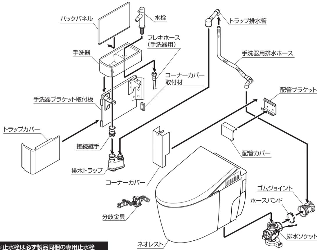
※止水栓は必ず製品同梱の専用止水栓(フィルター付き)を取り付けてください。
