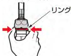
2-2 スリーブを回し、凹部と凸部を合わせ、スリーブを下げてホースを引き抜く。
