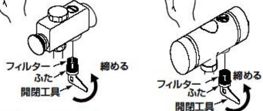
※再度、フィルターを取り出す際は、フィルターを掃除してください。また、整流網を忘れずに取り付けてください。
