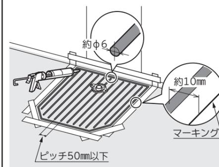
接着剤を床面にコーキングガンで塗る。接着剤は必ず同送している「専用接着剤」を使う。
