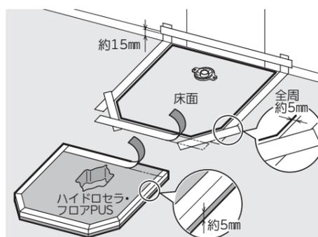
「床面」と「ハイドロセラ・フロアPUS」の両方にマスキングする。
