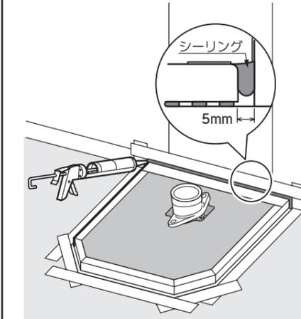
シーリングを塗布した後に、「コーキング用ヘラ」で押さえる。シーリング処理には、同送付属の「専用接着剤」が使用可能です。
