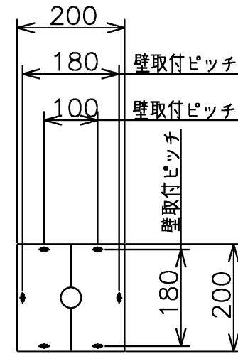
エアブローⅡ配管取出口カバー
