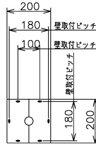
エアブローⅡ配管取出口カバー
