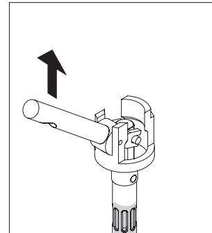
④ハンドル部を上方に持ち上げ開閉ロッドごと垂直に引抜きます。
