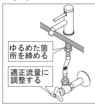
⑩①でゆるめた箇所を締め、止水栓を開き作動を確認します。
