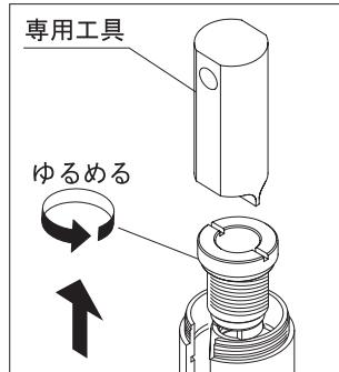
⑤工具でシートガイドをゆるめ垂直に引上げ外し、本体内部のゴミを除去します。
