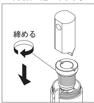
⑥新しいシートガイドを本体に垂直に挿入し工具で締付けます。
