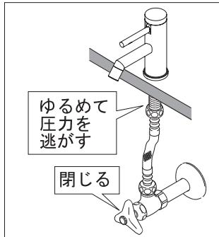
①止水栓と本体の間の1箇所をゆるめ水栓内の圧力を逃がします。
