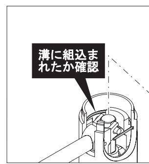
⑧Cリングを本体の溝に組込みます。ハンドル部を上に引張り、Cリングが溝におさまったか確認をします。
