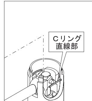
③ラジオペンチなどで、Cリングの直線部をつかみ取外します。
