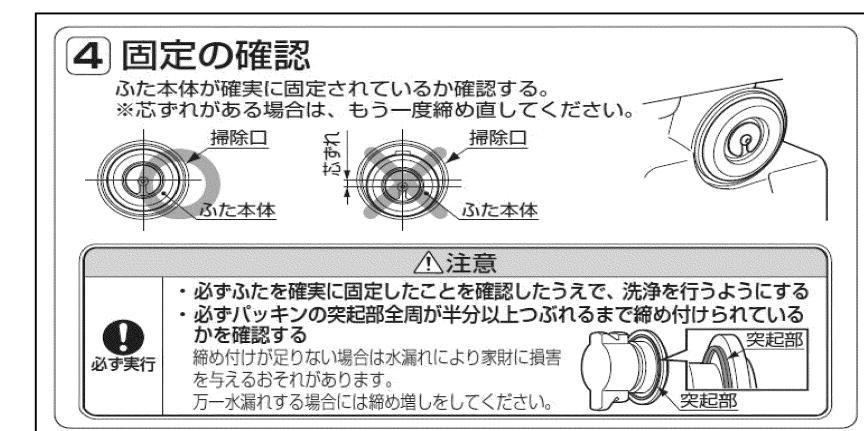
今回の三代目掃除口ユニットHH05162Zは、部品同士の取り合いをより細かく突きつめ、『あそび』を無くすように設計しており、締め付けていくにつれ、陶器掃除口の中心にふたが来るようになっています。
