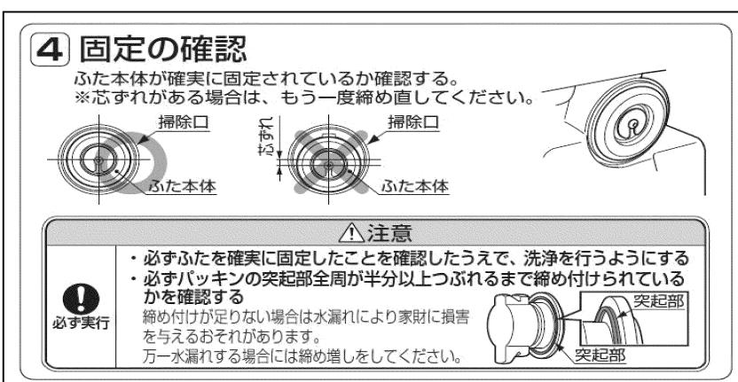
今回の三代目掃除口ユニットHH05162Zは、部品同士の取り合いをより細かく突きつめ、『あそび』を無くすように設計しており、締め付けていくにつれ、陶器掃除口の中心にふたが来るようになっています。
