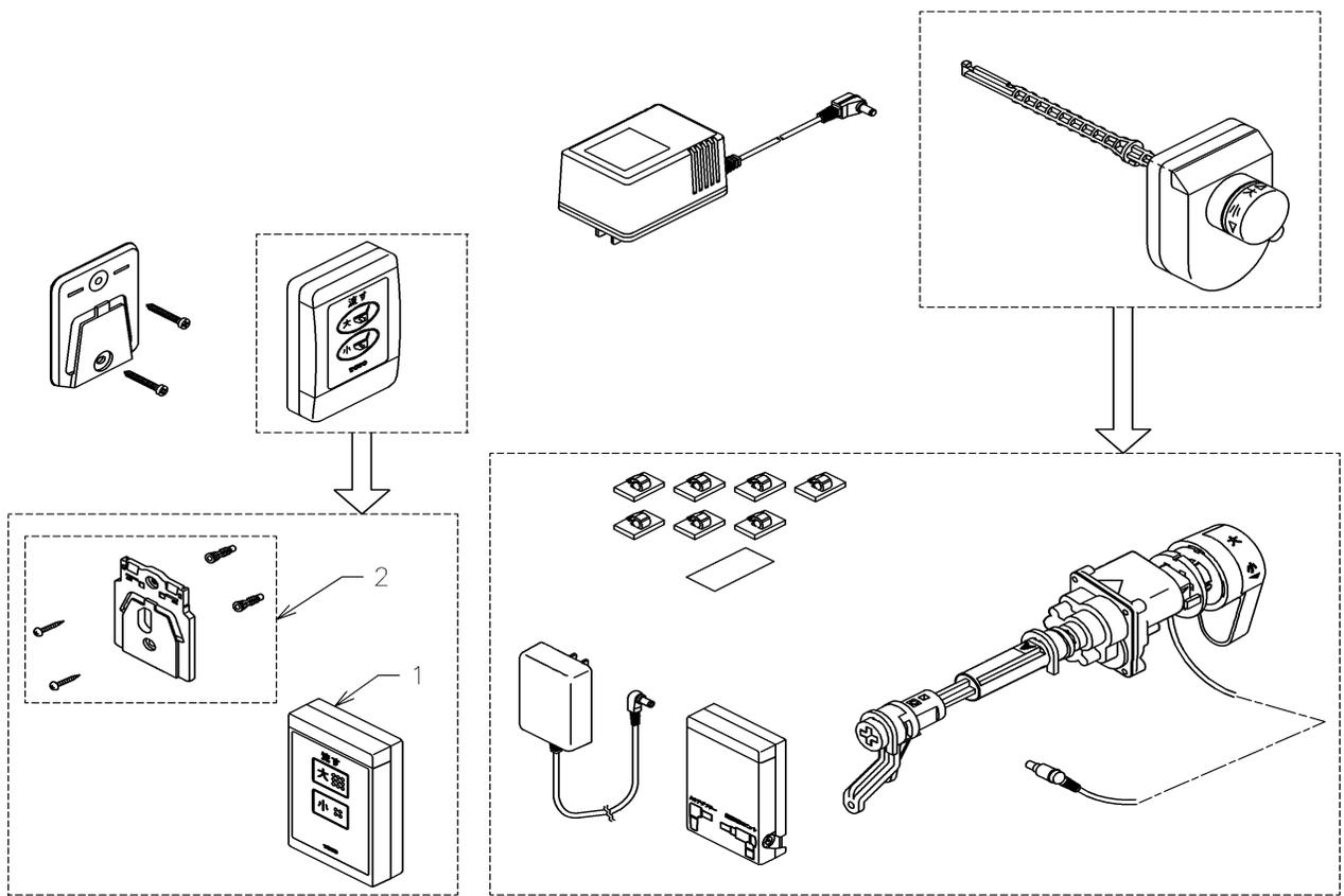
\*リモコンハンガーには新旧互換性がないので、リモコン交換時にはリモコンハンガーも合わせて交換してください。
