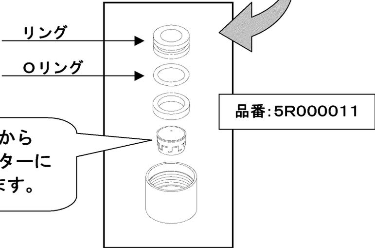
リングにOリングを組み付けて水栓本体に押し込み、吐水口部を取り付けて下さい。
