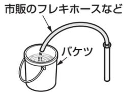
市販のフレキホースなどとバケツを準備し、給水・給湯管に市販のフレキホースを接続して、給水・給湯管内のごみ、砂などを洗い流してください。
