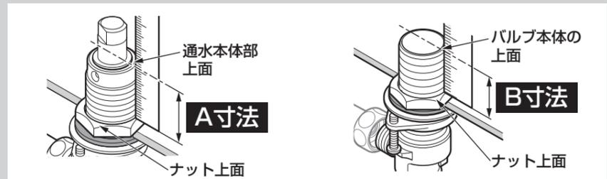
⑥ 高さ測定後、連結管を本固定する。
