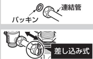
④ 連結管を接続後、通水本体部・バルブ本体の本体取付ナットをねじ込み、プレート下面に押し付ける。
