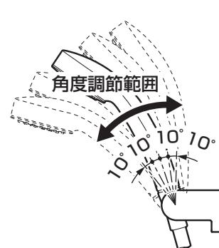
シャワーハンガーにシャワーヘッドを確実にセットして角度を変える。
