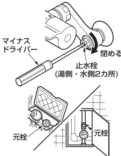
マイナスドライバーを差し込み、止水栓を閉める。
