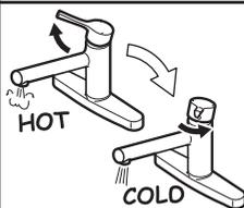
給水圧力は給湯圧力より必ず高くするか、同圧にする
