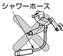
**解氷機（凍結した水道管などに電流を流して解凍する装置）を使用する場合、水栓には通電しない**
