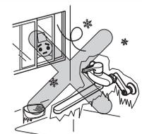
**凍結が予想される際は、配管と水栓の水抜き操作を同時に行う**
