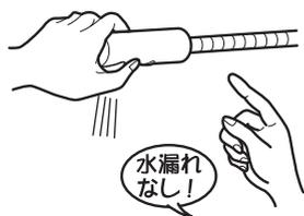
**8** ハンドシャワーを引き出した状態で水を出し、ホース接続部からの水漏れがないことを確認する。
