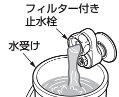
バケツなど水受けとなるものを準備し、壁や床に水が飛び散らないよう止水栓をゆっくり開き、給水・給湯管内のごみ、砂などを洗い流す。
