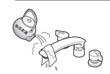
水抜きを行っても吐水口の網目に付着 した水滴が凍り、通水後も少しの間、 水が出ない場合があります。
