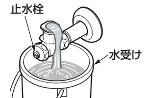
バケツなど水受けとなるものを準備し、壁や床に水が飛び散らないよう止水栓をゆっくり開き、給水管内のごみ、砂などを洗い流す。
