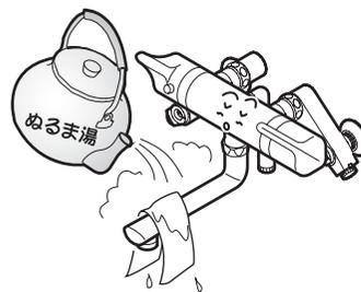
水抜きを行っても吐水口の網目やフィルターに付着した水滴が凍り、通水後も少しの間、水が出ない場合があります。そのときはタオルなどの布を巻き付け、しみこませるようにゆっくりとぬるま湯をかけてください。
