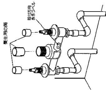
①取付方向を示すベルの面が浴槽側に向くように取付けてください。逆に取付けるとスパウトの取付けができなくなります。
