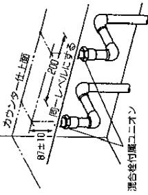
洗面台のユニオンを接続し、カウンター上上面までの寸法が77±10mmになるように施工してください。
