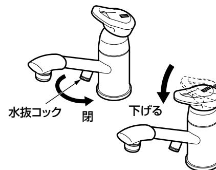
水抜コックが閉まっていることを確認し、レバーハンドルを下げるから（水が出ない状態）通水を再開してください。
