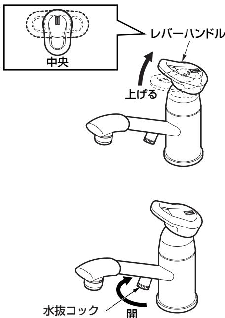
1. 配管部の水抜栓などにより通水を止めて、水抜きを行う。
