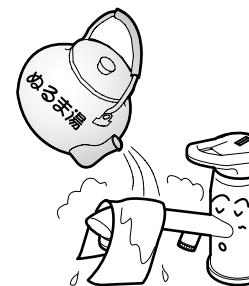
水抜きを行っても吐水口の網目に付着した水滴が凍り、通水後も少しの間、水が出ない場合があります。そのときはタオルなどの布を巻き付け、しみこませるようにゆっくりとぬるま湯をかけてください。
