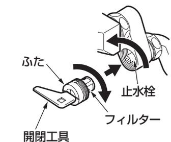
1. 開閉工具で湯側・水側の止水栓を閉める。
