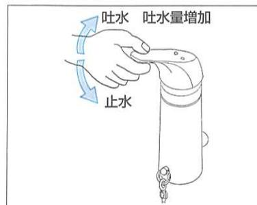
どの位置でも、レバーハンドルを上げると吐水し、下げると止水します。吐水量はレバーハンドルを上げるにしたがって多くなります。
