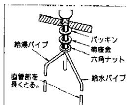
②逆止弁 (寒冷地用の場合はソケット) を止水栓に仮固定した後、給水・給湯パイプの必要長さをあたり、切断してください。このとき、パイプの差込代は約25mm確保してください。
