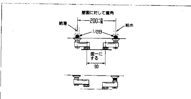
\*寒冷地用TK180U型の場合は止水栓の取付位置が本体よりも上になると、水抜きができませんので必ず下になるように取り付けてください。
