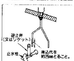
③給水・給湯パイプに袋ナット、テーパリング、パッキンガイド、パッキンの順に入れて、逆止弁 (又はソケット) を差し込んでください。次に逆止弁 (又はソケット) を止水栓にねじ込み、混合栓本体を本固定してください。固定には別売の綿付専用工具 (TZ33、TZ36) を利用して確実に締め付けてください。
