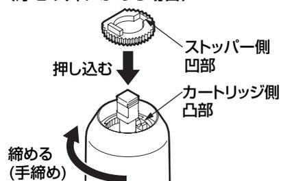
※カートリッジ押えの歯とストッパーの歯が合わないときは、カートリッジ押えを**締め込む方向**にて歯を合わせるように調整してください。
