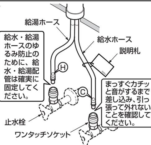
給水・給湯ホースのゆるみ防止のために、給水・給湯配管は確実に固定してください。
