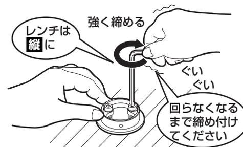
⑧ さらに六角棒レンチを横にしてボルトを**1回転増締めして**確実に固定する。
