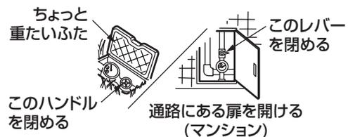
②切替ハンドルのレバーを水栓本体のポイントまたはラインの位置(水が出ない状態)に戻し、水が出ないことを確認する。
