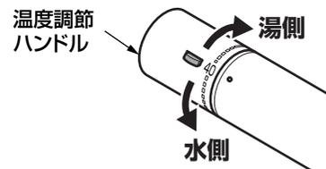
2. 流量が15L/分程度(洗面器一杯にするのに約15秒弱)になるように水側止水栓で調節する。
