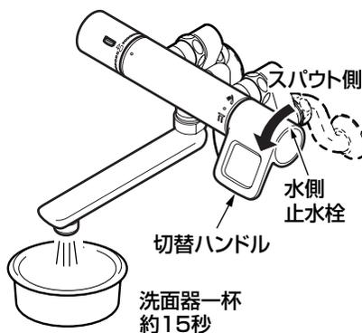
3. 温度調節ハンドルを安全ボタンを押しながら上(湯側)いっぱい回し、2.と同じように湯側止水栓で流量を調節する。
