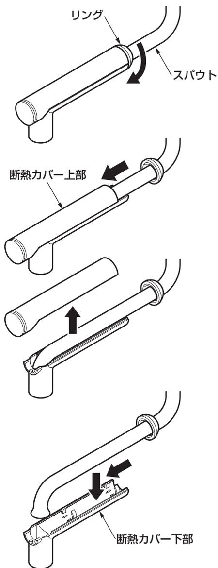
1. リングを反時計回りに回し、熱湯専用スパウトの根元側へ引っ張る。
