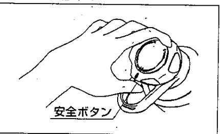
誤って熱湯を出さないように安全ボタンが付いています。温度調節ハンドルは目盛“40”付近でロックされますのでこれより高温で吐水したいときは、安全ボタンを押して回してください。なお、安全ボタンを押して使用したあとは、ハンドルを必ず目盛“40”以下に戻しておいてください。
