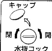
キャップを外し、穴の奥の水抜き栓をマイナスドライバー等で、開閉してください。
