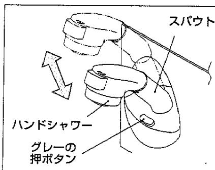
スパウトを高くしたい時は、そのまま引き上げ、下げる時はグレーの押ボタンを押しながら、ハンドシャワーを押し下げてください。好みの高さで固定できます。
