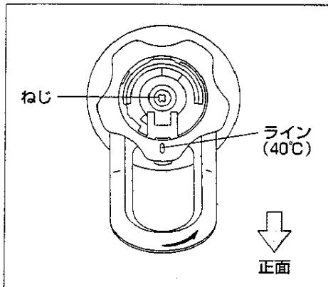
⑤温度調節ハンドルのラインが、正面（インデックス“40”的位置）を向く様に、温度調節ハンドルを固定してください。
