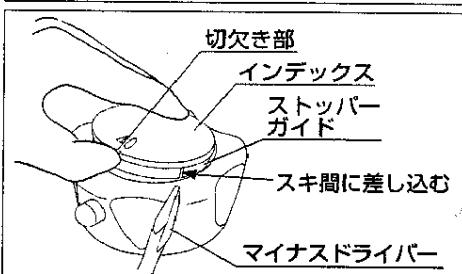
②マイナスドライバー等を切欠き部に差し込みインデックスを浮かせ、指で起してください。
