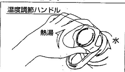
温度調節ハンドルを回してハンドルの目印をお好みの温度に合わせて下さい。目盛“40”は目安として下さい。
