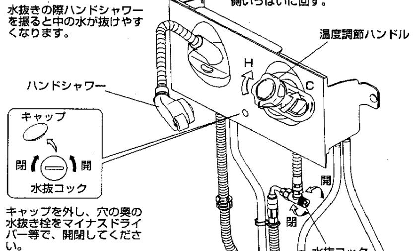
キャップを外し、穴の奥の水抜き栓をマイナスドライバー等で、開閉してください。
