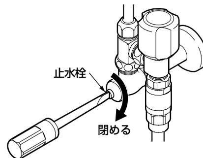
マイナスドライバーを差し込み、止水栓を閉める。
