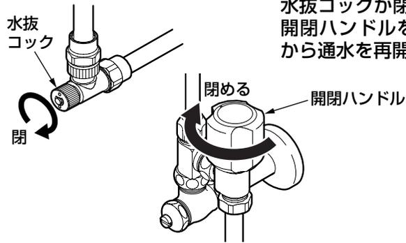
水抜コックが閉まっていることを確認し、開閉ハンドルを閉めて（水が出ない状態）から通水を再開してください。
