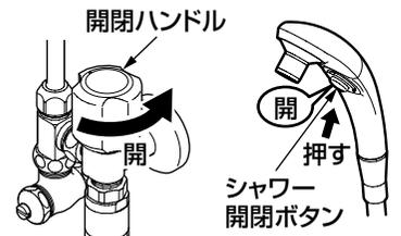
**開閉ハンドルを反時計回りに回し、シャワー開閉ボタンを押す。**
